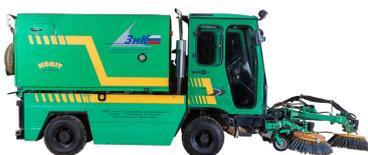
Машина коммунальная МК-1500М2 предназначена для подметания и транспортирования смёта в бункере, с последующей выгрузкой способом самосвала. Захват и загрузка смёта производится подметальной и вакуумной системой, позволяющей производить экологически чистую уборку. Коммунально уборочная машина незаменима для жилищно-коммунальных хозяйств и служб благоустройства в любое время года.
