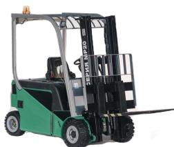
Электропогрузчики серии МР20 предназначены для перемещения и укладки грузов на открытых площадках и в закрытых помещениях: на базах, в складах, в пакгаузах, в трюмах судов, в железнодорожных вагонах и других местах, оборудованных твердым и ровными покрытием.
